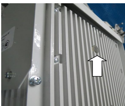
Рисунок 4 - Схема пломбировки модуля радиолокационного измерения скорости
