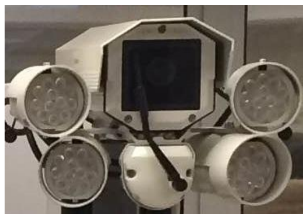
Рисунок 2 - Общий вид комплекса (видео модуль с модулями ИК подсветки и модулем очистки)
