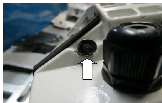
Рисунок 5 - Схема пломбировки видео модуля
